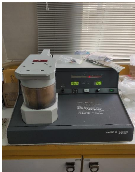
شکل ۲- پوشش‌دهی دانه‌های گرده با دستگاه sputter coater در ارقام زودرس و میان‌رس گلابی آسیایی و گلابی اروپایی رقم شاه‌میوه با طلا در آزمایشگاه میکروسکوپ الکترونی دانشگاه امیرکبیر (۱۴۰۱/۰۲/۰۸)
